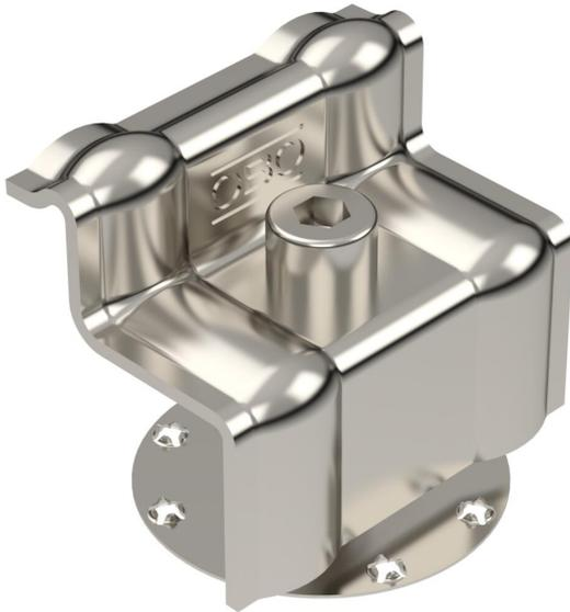
Abrazadera final con muelle para la fijación de módulos fotovoltaicos en perfiles de soporte. Apto para ancho de ranura de 10 mm. Fijación atornillable del módulo fotovoltaico con llave Allen tamaño 6.
