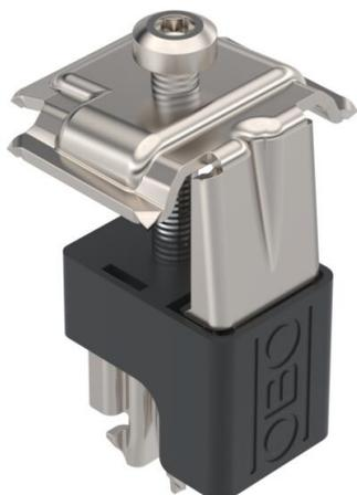
Abrazadera universal para el montaje de módulos fotovoltaicos en tejados planos e inclinados, adecuada como abrazadera entre 2 módulos o como abrazadera final. Fijación previa por encaje al perfil de soporte TP 45 y a los soportes STK y STL. Apta para ancho de ranura de 10 mm. Una vez encajada, puede girarse 90°. Fijación atornillada del módulo FV con llave Torx 30.
