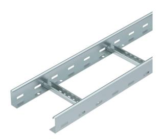
Bandeja de escalera con barra lateral perforada de ala 60 mm con peldaños de perfil en C abiertos hacia arriba (modelo VS), remachados. La bandeja de escalera se suministra plegada.
