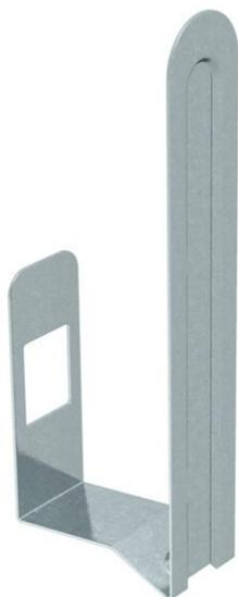
Los retenedores sujetan el cable y las líneas al canal facilitando la instalación a la pared y al techo. Los retenedores se fijan en el interior del canal. Para ancho de canal de 150 mm y 200 mm.
