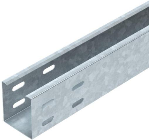
Bandeja portacables sin perforar de peso medio para tendido horizontal de cables y líneas. Según EN 61537. De uso en interiores y exteriores. Conexión atornillada. Adecuado para montaje elevado directo en el suelo, y montaje en pared y techo sobre sistema portante. Con orificios de conexión en el extremo de la bandeja portacables.
