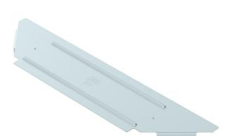
Tapa para pieza moldeada de derivación para bandejas portacables encajables y atornillables en interiores y exteriores, para proteger los cables frente a daños y suciedad. Sujeción mediante apoyo de la tapa de tramo. Apto para todas las alturas de ala
