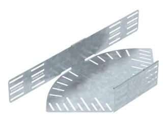
Curva de ángulo regulable para establecer una derivación horizontal, accesorio para bandejas portacables encajables y atornillables con ala de 110 mm. Ángulo regulable de 0-90 °. Montaje sin tornillos con abrazaderas dobles o unión atornillada con tornillos redondos planos FRS y tuercas combinadas M6. De uso en interiores y exteriores. El material de fijación se debe pedir por separado.
