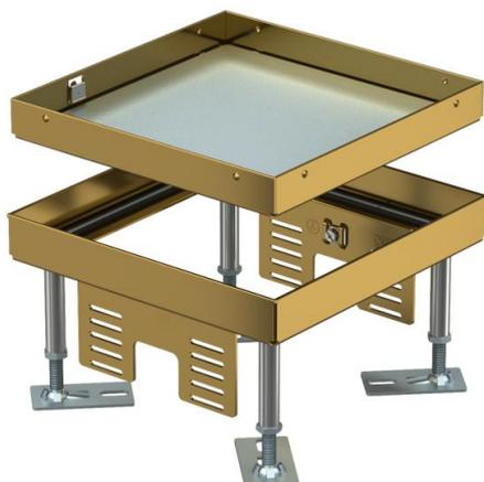
Conjunto de tapa y marco cuadrado "ciego" de altura regulable para crear una abertura de inspección de tamaño nominal 4. Montaje en sistemas de canalización, suelos dobles y huecos en suelos limpiados en seco o en húmedo en interiores. Sólo son apropiados para pavimentos pulidos. Para la instalación de 2 soportes universales UT3 para 4 mecanismos individuales con anillo/estribo de soporte o 6 dispositivos Modul 45®. Pueden instalarse 2 tapas ciegas APMT2.
