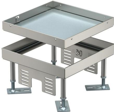
Conjunto de tapa y marco cuadrado "ciego" de altura regulable para crear una abertura de inspección de tamaño nominal 4. Montaje en sistemas de canalización, suelos dobles y huecos en suelos limpiados en seco o en húmedo en interiores. Sólo son apropiados para pavimentos pulidos. Clase de protección: IP X5.
