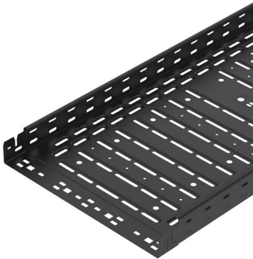
Bandeja portacables con sistema de fijación rápida integrado. Superficie galvanizada en banda, con recubrimiento en polvo de color negro intenso (RAL 9005). Perforación lateral continua de 7 x 20 mm para la instalación de componentes de unión y de montaje adicionales. Con perforación de 11 mm en el suelo para la suspensión directa de la varilla roscada. Longitud útil 3.000 mm. Amortiguación magnética sin tapa 20 dB, con tapa 50 dB.
