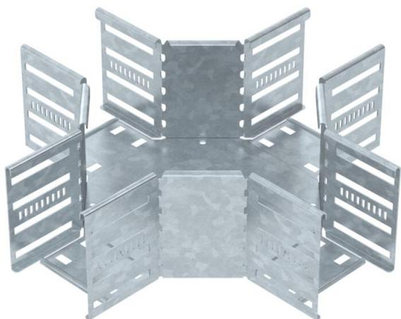
Cruce para establecer una derivación horizontal, accesorio para bandejas portacables encajables y atornillables con ala de 110 mm. Montaje sin tornillos con abrazaderas dobles o unión atornillada con tornillos redondos planos FRS y tuercas combinadas M6. De uso en interiores y exteriores. El material de fijación se debe pedir por separado.
