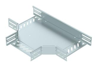
Pieza en T para establecer una derivación horizontal, accesorio para bandejas portacables encajables y atornillables con ala de 60 mm. Montaje sin tornillos con abrazaderas dobles o unión atornillada con tornillos redondos planos FRS y tuercas combinadas M6. De uso en espacio interior. El material de fijación se debe pedir por separado.
