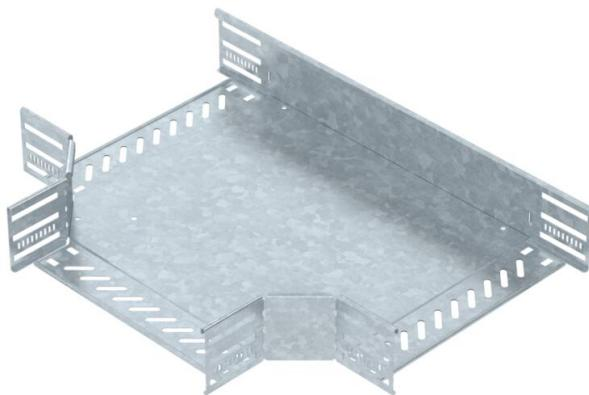
Pieza en T para establecer una derivación horizontal, accesorio para bandejas portacables encajables y atornillables con ala de 85 mm. Montaje sin tornillos con abrazaderas dobles o unión atornillada con tornillos redondos planos FRS y tuercas combinadas M6. De uso en interiores y exteriores. El material de fijación se debe pedir por separado.
