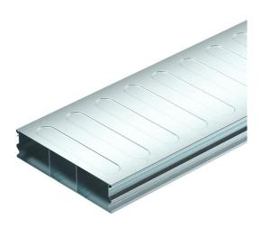
Canal para suelo (2 piezas) para el tendido de cables y líneas en sistemas bajo suelo con revestimiento de solado según la norma EN 50085-2-2. Tapa del canal desmontable y de encaje continuo. Con tabique separador en la parte inferior del canal. Sólo compatible con la UZD250-4/350-4.
