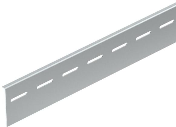
Chapa protectora para colocación lateral como protección sincronizada para el sistema de bandejas portacables transitable. La chapa protectora se puede instalar en los apoyos en Z con los tornillos de chapa de cabeza rebajada del tipo SPHS.
