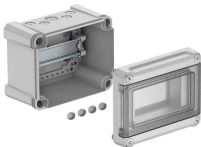
Distribuidor pequeño para el montaje empotrado, para subdistribución de corriente en interiores y exteriores protegidos, según IEC 439-3. Con carril en U pre-montado de 35 mm. Tipo de protección IP66 y grado de protección IK06. Tapa transparente para atornillar, con sección.
