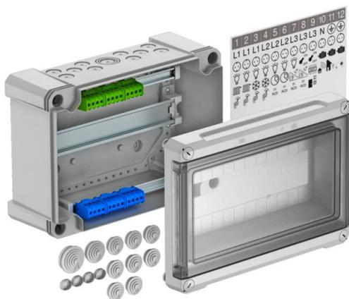
Distribuidor pequeño con regleta de bornes para el montaje empotrado, para subdistribución de corriente en interiores y exteriores protegidos, según IEC 439-3. Con carril en U premontado de 35 mm. Tipo de protección IP66 y grado de protección IK06. Tapa transparente para atornillar, con sección.
