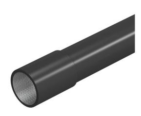
Tubo para instalaciones eléctricas según EN 61386-1, con extremos roscados según DIN EN 60423, para la protección mecánica de cables y conductores. Con pared interior sin rebabas. Clase de protección contra la corrosión 2 (media). Por cada tubo ya se ha enroscado un manguito de unión.
