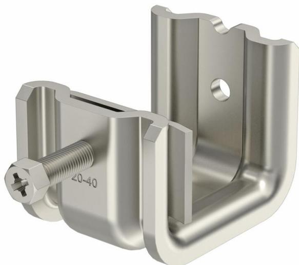
Este tipo de abrazadera de sujeción se desliza sobre el soporte y se fija al mismo, o al acero plano, mediante una cubeta de presión y un tornillo (M8). El tornillo de cabeza hexagonal tiene un ancho de llave de 10 mm. En el cuerpo de abrazadera se instalan además otras dos roscas M6 para fijar por ejemplo varillas roscadas.
