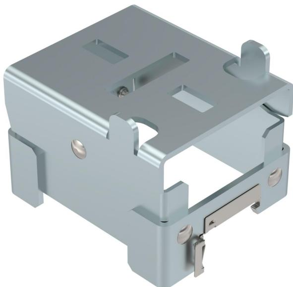
Soporte corto para montar módulos fotovoltaicos en tejados planos en combinación con el perfil de soporte TP 45/4700 y la abrazadera universal KLU. Ángulo de inclinación 15°. Fijación por encaje en perfil de soporte.
