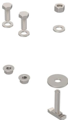
Juego de tornillos de cabezal hexagonal M12, tuercas de cabeza hexagonal con brida M12, tornillo de cabeza de gancho y arandelas. Para fijar cintas perforadas tipo LB FT en apoyos traseros de soportes premontados del sistema de montaje fotovoltaico en campo abierto.
