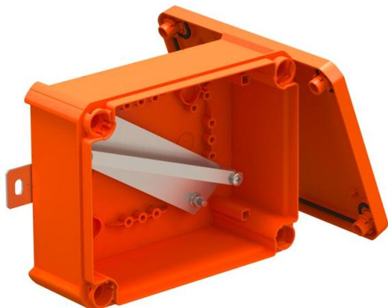
Caja de conexión o empalme de cables cerrada y sin montar para libre instalación con bornes cerámicos y prensaestopas. La dimensión A indica la longitud de carril de montaje disponible para los bornes de cableado. Suficiente espacio para cableado gracias a la disposición diagonal del carril de montaje. Fijación a bridas exteriores muy accesibles de acero inoxidable. Homologado para sistemas de cables con mantenimiento de función eléctrico según DIN 4102, parte 12, con las clases E30, E60 y E90.
