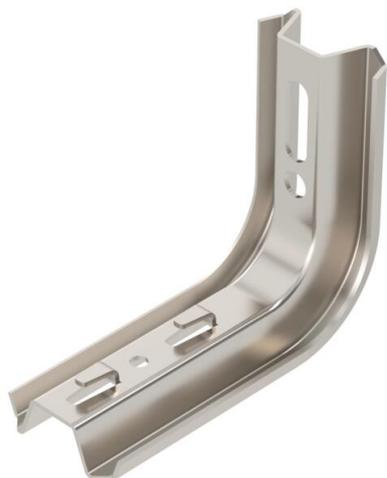
Escuadra TP con pestañas para la fijación de bandejas de rejilla sin tornillos. Si la escuadra se fija directamente al techo o se atornillan los perfiles contra el refuerzo frontal, debe instalarse una pieza distanciadora DS 4 por razones de estabilidad. Sobre la escuadra TP pueden fijarse sin tornillos las bandejas de rejillas de 50 x 100 mm p. ej. GRL, GR y GRM.
