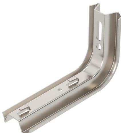
Escuadra TP con pestañas para la fijación de bandejas de rejilla sin tornillos. Si la escuadra se fija directamente al techo o se atornillan los perfiles contra el refuerzo frontal, debe instalarse una pieza distanciadora DS 4 por razones de estabilidad. Sobre la escuadra TP pueden fijarse sin tornillos las bandejas de rejillas de 50 x 100 mm p. ej. GRL, GR y GRM.
