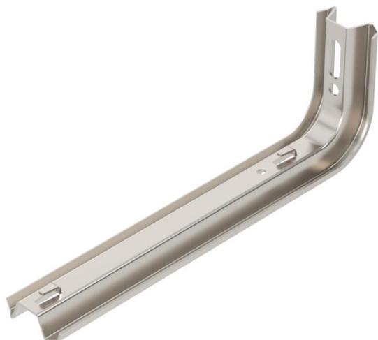
Escuadra TP con pestañas para la fijación de bandejas de rejilla sin tornillos. Si la escuadra se fija directamente al techo o se atornillan los perfiles contra el refuerzo frontal, debe instalarse una pieza distanciadora DS 4 por razones de estabilidad. Sobre la escuadra TP pueden fijarse sin tornillos las bandejas de rejillas de 50 x 100 mm p. ej. GRL, GR y GRM.
