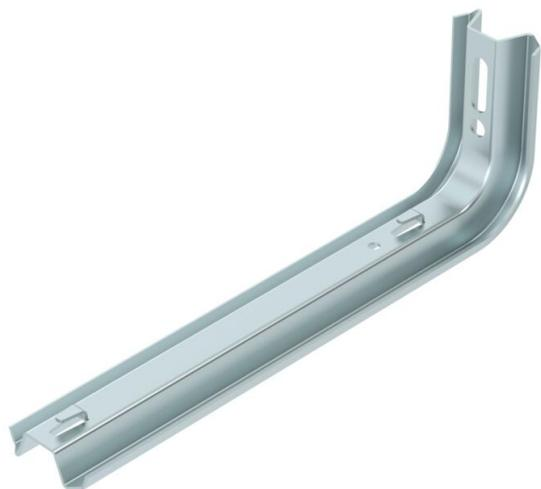
Escuadra TP con pestañas para la fijación de bandejas de rejilla sin tornillos. Si la escuadra se fija directamente al techo o se atornillan los perfiles contra el refuerzo frontal, debe instalarse una pieza distanciadora DS 4 por razones de estabilidad.
