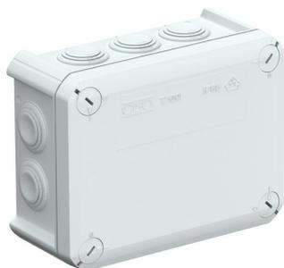
Caja de derivación según DIN EN 60670. Antiinflamable según DIN EN 60695-2-11, temperatura de ensayo 650 °C. Resistencia al impacto IK07 según DIN EN 50102.
