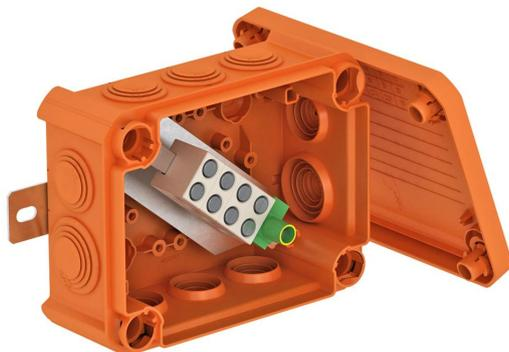
Caja de derivación sin halógenos con juntas insertables flexibles premontadas, homologada para el mantenimiento de función de sistemas eléctricos según la norma DIN 4102 parte 12. Clases de mantenimiento de función de E30 a E90.
