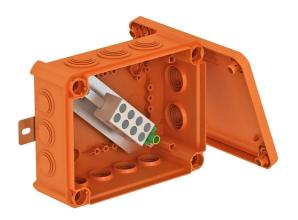
Caja de derivación sin halógenos con juntas insertables flexibles premontadas, homologada para el mantenimiento de función de sistemas eléctricos según la norma DIN 4102 parte 12. Clases de mantenimiento de función de E30 a E90.
