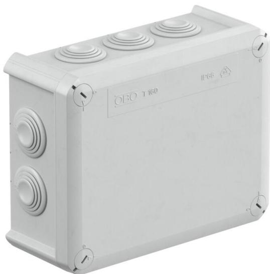
Caja de derivación para la conexión de cables y líneas en zonas interiores y zonas exteriores protegidas. Forma rectangular con juntas insertables en los lados y entradas ciegas en el suelo. Apropiado para el montaje en pared y techo, y el montaje en estructuras de chapa. Con la posibilidad de fijación interior y montaje mediante cúpulas esquineras. Tapa con cierre rápido, precintable. Fabricada con materiales libres de halógenos y resistentes a los rayos UV.
