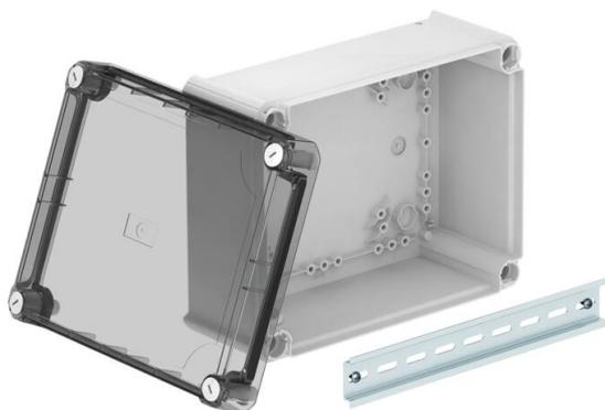
Caja de derivación cerrada para la conexión de cables y líneas en zonas interiores y zonas exteriores protegidas. Forma rectangular sin entradas. Apropiado para el montaje en pared y techo, el montaje en estructuras de chapas y rosca en el suelo. Con la posibilidad de fijación interior y montaje mediante cúpulas esquineras. Tapa alta, transparente con cierre rápido, precintable. Fabricada con materiales libres de halógenos y resistentes a los rayos UV.
