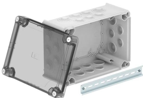
Caja de derivación para la conexión de cables y líneas en zonas interiores y zonas exteriores protegidas. Forma rectangular con juntas insertables. Apropiado para el montaje en pared y techo, el montaje en estructuras de chapas y rosca en el suelo. Con la posibilidad de fijación interior y montaje mediante cúpulas esquineras. Tapa alta, transparente con cierre rápido, precintable. Fabricada con materiales libres de halógenos y resistentes a los rayos UV.
