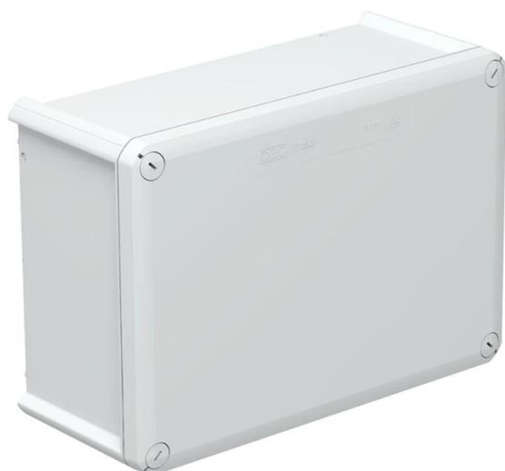
Caja de derivación cerrada para la conexión de cables y líneas en zonas interiores y zonas exteriores protegidas. Forma rectangular sin entradas. Apropiado para el montaje en pared y techo, el montaje en estructuras de chapas y rosca en el suelo. Con la posibilidad de fijación interior y montaje mediante cúpulas esquineras. Tapa con cierre rápido, precintable. Fabricada con materiales libres de halógenos y resistentes a los rayos UV.
