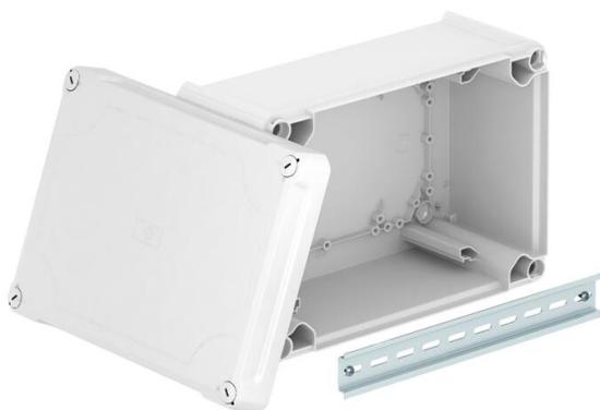
Caja de derivación cerrada para la conexión de cables y líneas en zonas interiores y zonas exteriores protegidas. Forma rectangular sin entradas. Apropiado para el montaje en pared y techo, el montaje en estructuras de chapas y rosca en el suelo. Con la posibilidad de fijación interior y montaje mediante cúpulas esquineras. Tapa alta con cierre rápido, precintable. Fabricada con materiales libres de halógenos y resistentes a los rayos UV.
