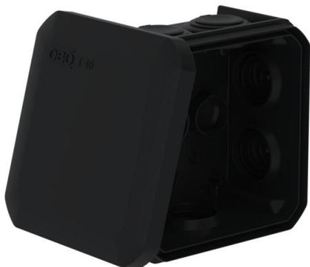
Caja de derivación para la conexión de cables y líneas en zonas interiores y zonas exteriores protegidas. Forma cuadrada con juntas insertables en los lados y entradas ciegas en el suelo. Apropiado para el montaje en pared y techo, y el montaje en estructuras de chapa. Con la posibilidad de fijación interior. Con tapa de bornes fija. Fabricada con materiales libres de halógenos y resistentes a los rayos UV.
