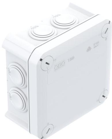
Caja de derivación para la conexión de cables y líneas en zonas interiores y zonas exteriores protegidas. Forma cuadrada con juntas insertables en los lados y entradas ciegas en el suelo. Apropiado para el montaje en pared y techo, y el montaje en estructuras de chapa. Con la posibilidad de fijación interior y montaje mediante cúpulas esquineras. Tapa con cierre rápido, precintable. Fabricada con materiales libres de halógenos y resistentes a los rayos UV.
