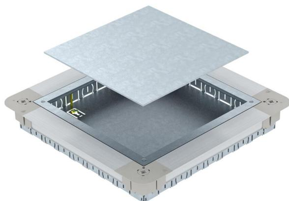
Caja portamecanismos con tapa de montaje y placa ciega con paredes laterales de chapa de acero. Para el montaje de una caja portamecanismos cuadrada GES9 55 en pavimentos a partir de 55 mm de altura. Se puede nivelar de forma continua a la altura de pavimento y el pavimento puede montarse a ras del borde de extracción del pavimento. Con aberturas para introducción de tubos en cada lado 7 x M20, 3 x M25, 4 x M32. Tamaño útil de tubo con una altura de sistema de 55 mm: M20.
