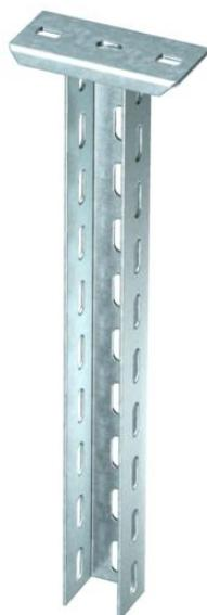
Soporte colgante (perfil en U) de medidas 50 x 50 mm con cabeza soldada. Para fijación en techos de hormigón y vigas metálicas horizontales. Con escuadras a partir de 400 mm de ancho o en caso de que la escuadra se instale en el extremo del perfil colgante, se recomienda utilizar la pieza distanciadora DSK 45.
