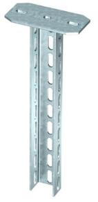
Soporte colgante (perfil en U) de medidas  $70 \times 50$  mm con cabeza soldada. Para fijación en techos de hormigón y vigas metálicas horizontales. Con escuadras a partir de 400 mm de ancho o en caso de que la escuadra se instale en el extremo del perfil colgante, se recomienda utilizar la pieza distanciadora DSK 61.
