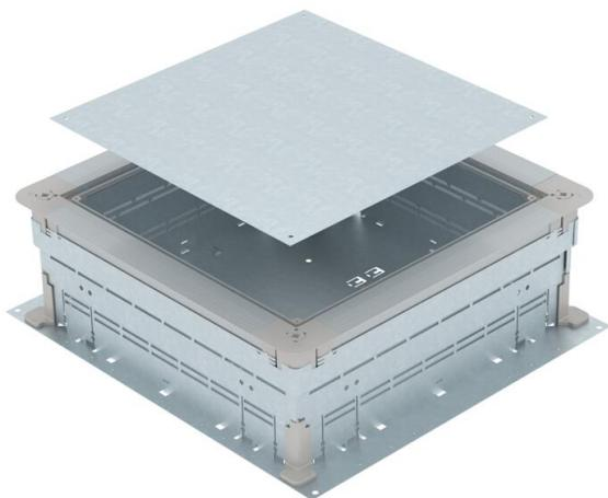
Caja de derivación y de registro bajo suelo para sistemas de canalización bajo pavimento con paredes laterales de chapa de acero. Para el montaje de unidades en tapa de montaje (pedir por separado). Se puede nivelar de forma continua a la altura de pavimento (es posible una nivelación rápida) y el pavimento puede montarse a ras del borde de extracción. Con posibilidad de desacoplamiento acústico tras el montaje de pavimento y de aplicación de cargas pesadas con accesorios adicionales.
