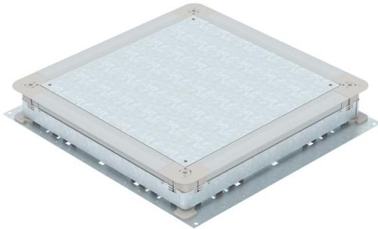
Caja de derivación y de registro bajo suelo para sistemas de canalización bajo pavimento con paredes laterales de chapa de acero. Para el montaje de unidades en tapa de montaje (pedir por separado). Se puede nivelar de forma continua a la altura de pavimento (es posible una nivelación rápida) y el pavimento puede montarse a ras del borde de extracción. Con posibilidad de desacoplamiento acústico tras el montaje de pavimento y de aplicación de cargas pesadas con accesorios adicionales.
