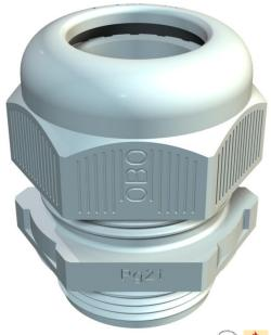
Prensaestopas con rosca de conexión métrica PG de tipo con tuerca de capuchón, para cajas de derivación, carcasa, cajas de distribución en sector privado e industrial. Con descarga de tracción y labio de sellado integrado , probado según DIN EN 62444. Clase de protección IP68. Se puede utilizar entre -20 °C y +65 °C.
