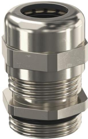
Prensaestopas robusto con rosca de conexión métrica según IEC 423 de tipo con tuerca de capuchón para situaciones donde se exige una elevada estanqueidad. Descarga de tracción, protección contra la torsión y estanqueidad a lo largo de toda la zona de apriete. Empaquetadura de neopreno. Bloque de terminales de poliamida. Con junta de sellado premontada en rosca métrica, probado VDE según DIN EN 50262, grado de protección IP68 a 5 bar/1 h, rango de temperatura entre -20 y +100 °C.
