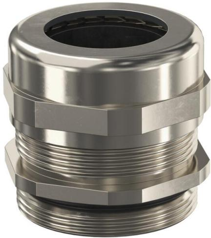
Prensaestopas robusto con rosca de conexión métrica según IEC 423 de tipo con tuerca de capuchón para situaciones donde se exige una elevada estanqueidad. Descarga de tracción, protección contra la torsión y estanqueidad a lo largo de toda la zona de apriete. Empaquetadura de neopreno. Bloque de terminales de poliamida. Con junta de sellado premontada en rosca métrica, probado VDE según DIN EN 50262, grado de protección IP68 a 5 bar/1 h, rango de temperatura entre -20 y +100 °C.
