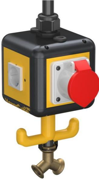
Carcasa equipada y precableada con 1 m de tubo 1/2" y conexión para manguera de aire comprimido 13 x 3,5 mm y distribuidor de 2 vías 1/2", con tuerca cáncamo, ganchos de agarre y 4 cubiertas protectoras.
