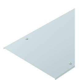
Tapa con tornillo giratorio para Bandeja portacables de amplios vanos y bandeja de escalera de amplios vanos con una altura lateral de 110 y 160 mm. Reborde transversal a partir de 500 mm de ancho.
