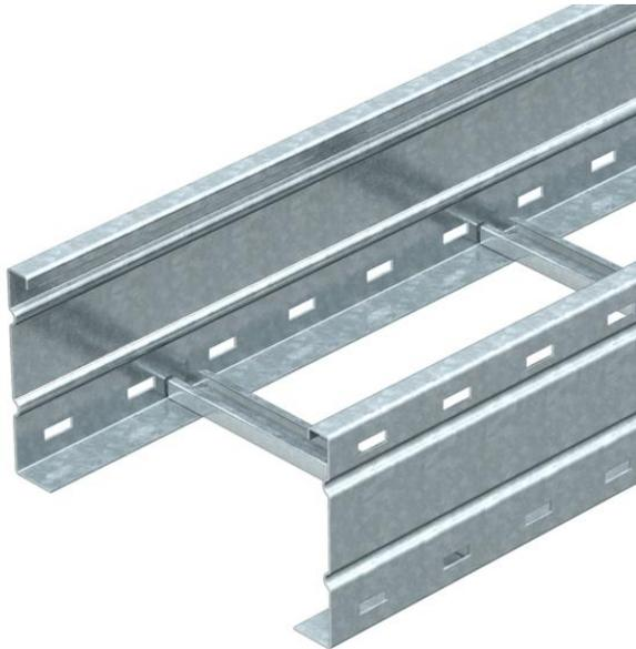
Bandeja de escalera de vano ancho con barrera lateral perforada ala de 160 mm. Fijación de cables y tubos con abrazadera tipo 2056. Las uniones rectas WRV 160 se piden por separado. Aislamiento magnético sin tapa 10 dB, con tapa 15 dB.
