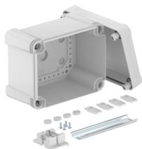
Caja de derivación con carril DIN para la conexión de cables y líneas en zonas interiores y zonas exteriores. Forma rectangular sin entradas. Apropiado para el montaje en pared y techo con la posibilidad de fijación exterior, interior o montaje en las esquinas. Particularmente resistente a los impactos con IK09. Tapa con cierre rápido, precintable. Fabricada con materiales libres de halógenos y resistentes a los rayos UV.
