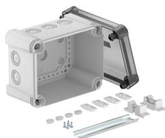
Caja de derivación con carril DIN para la conexión de cables y líneas en zonas interiores y zonas exteriores. Forma rectangular con entradas ciegas. Apropiado para el montaje en pared y techo con la posibilidad de fijación exterior, interior o montaje en las esquinas. Particularmente resistente a los impactos con IK09. Tapa transparente con cierre rápido, precintable. Fabricada con materiales libres de halógenos y resistentes a los rayos UV.
