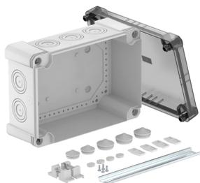
Caja de derivación con carril DIN para la conexión de cables y líneas en zonas interiores y zonas exteriores. Forma rectangular con entradas ciegas. Apropiado para el montaje en pared y techo con la posibilidad de fijación exterior, interior o montaje en las esquinas. Particularmente resistente a los impactos con IK09. Tapa transparente con cierre rápido, precintado. Fabricada con materiales libres de halógenos y resistentes a los rayos UV.
